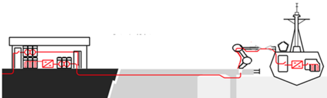
Figur 19 Prinsippskisse av ladestasjon på land
