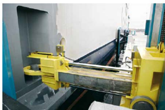
Figur 9.4 Løsning for automatisk fortøyning (Kilde: TTS)
